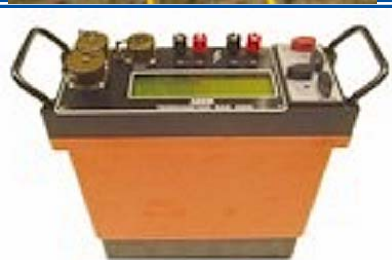
Terrameter SAS 4000, 4 - канальная ABEM, Швеция
